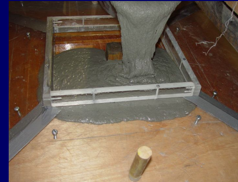
Concretagem em forma de acrílico
